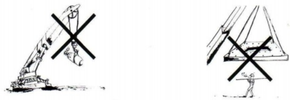
รูป แสดงการยกอุปกรณ์ผิดวิธี และห้ามผู้ปฏิบัติงานยืนหรือเดินผ่านขณะที่ปั้นจั่นกำลังยกของ
