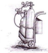
รูป แสดงชุดควบคุมความดันและรถเข็นถังแก๊สสำหรับเคลื่อนย้ายอย่างปลอดภัย
