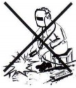
รูป การห้ามนำสายเชื่อมพันรอบตัวขณะทำงานเพราะอาจได้รับอันตรายจากกระแสไฟฟ้ารั่วหรือช็อตได้
