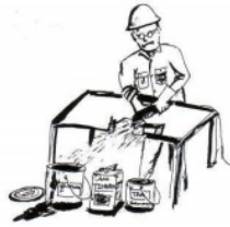
รูป แสดงการห้ามใช้อุปกรณ์ไฟฟ้าที่ทำให้เกิดประกายไฟใกล้กับบริเวณที่เก็บสารเคมีไวไฟ
